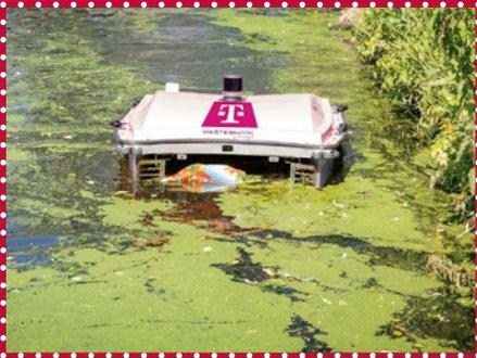
Die autonom schwimmende Drohne WasteShark nutzt Positionierungstechnik der Telekom zur Reinigung von Flüssen
